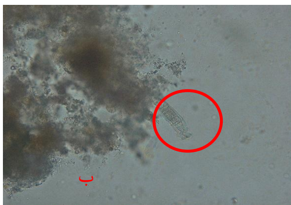
شکل ۵- تصویر میکروسکوپ نوری از بافت لجن فعال (الف) قبل از سازگاری (ب) بعد از سازگاری
