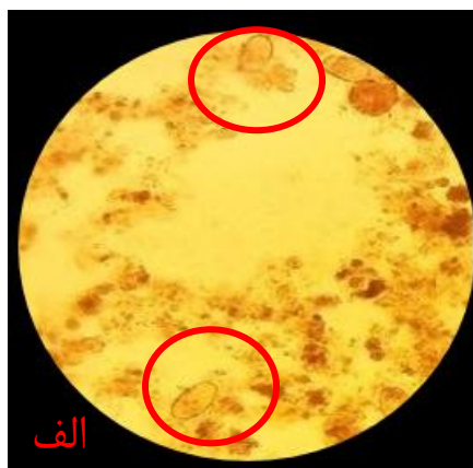
شکل ۵- تصویر میکروسکوپ نوری از بافت لجن فعال (الف) قبل از سازگاری (ب) بعد از سازگاری
