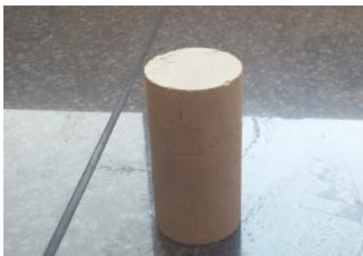
شکل ۱- نمونه مغزه کربناته استفاده شده در آزمایش های آشام خودبخودی
