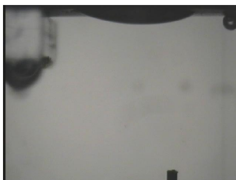
شکل ۴- قطره نفت قرار گرفته بر روی سطح سنگ نفت دوست شده
