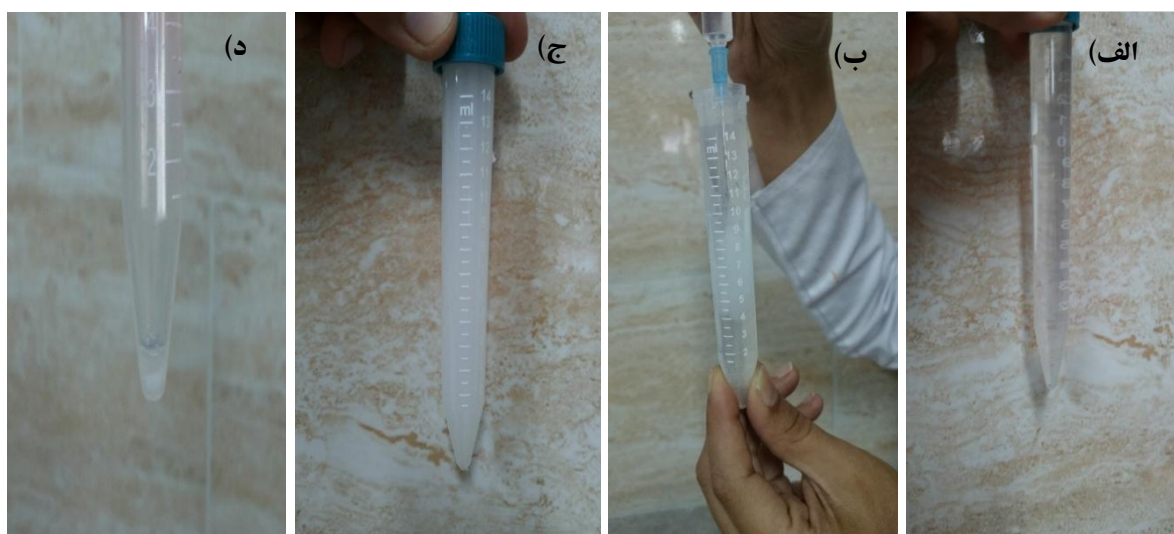
شکل ۱: تصاویر مراحل مختلف آزمایش. الف) محلول نمونه ب) در حین تزریق ماده جاذب به همراه حلال پخشی ج) تشکیل حالت ابری شکل در محلول نمونه د) ته‌نشینی جاذب استخراج شده پس از سانتریفیوژ
