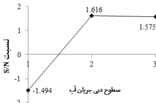
شکل ۳. نمودار نسبت S/N برای سطوح مختلف دبی جریان آب: (۱) ۱ میلی‌لیتر بر دقیقه، (۲) ۲ میلی‌لیتر بر دقیقه، (۳) ۴ میلی‌لیتر بر دقیقه
